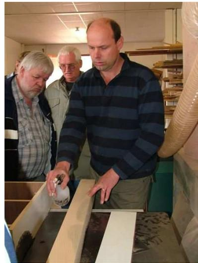
**Spraying Holz-Gleit on Table Saw**
